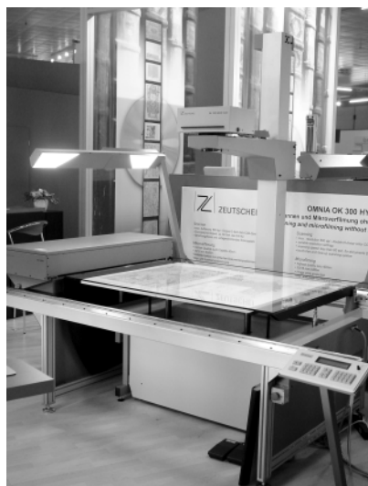
La station hybride Omnia OK 300 avec sa caméra pour microfilm
