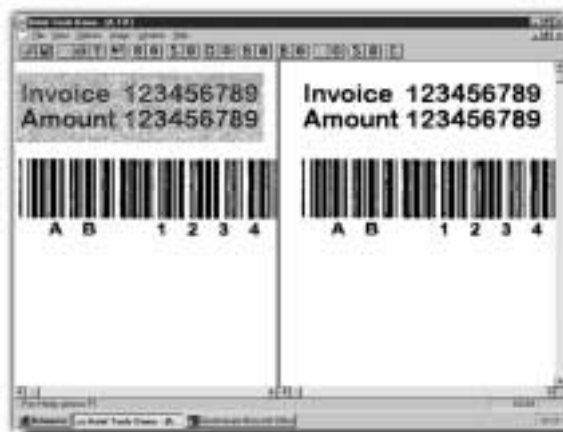
Exemple de traitement des images numérisées : suppression de fond et augmentation du contraste
